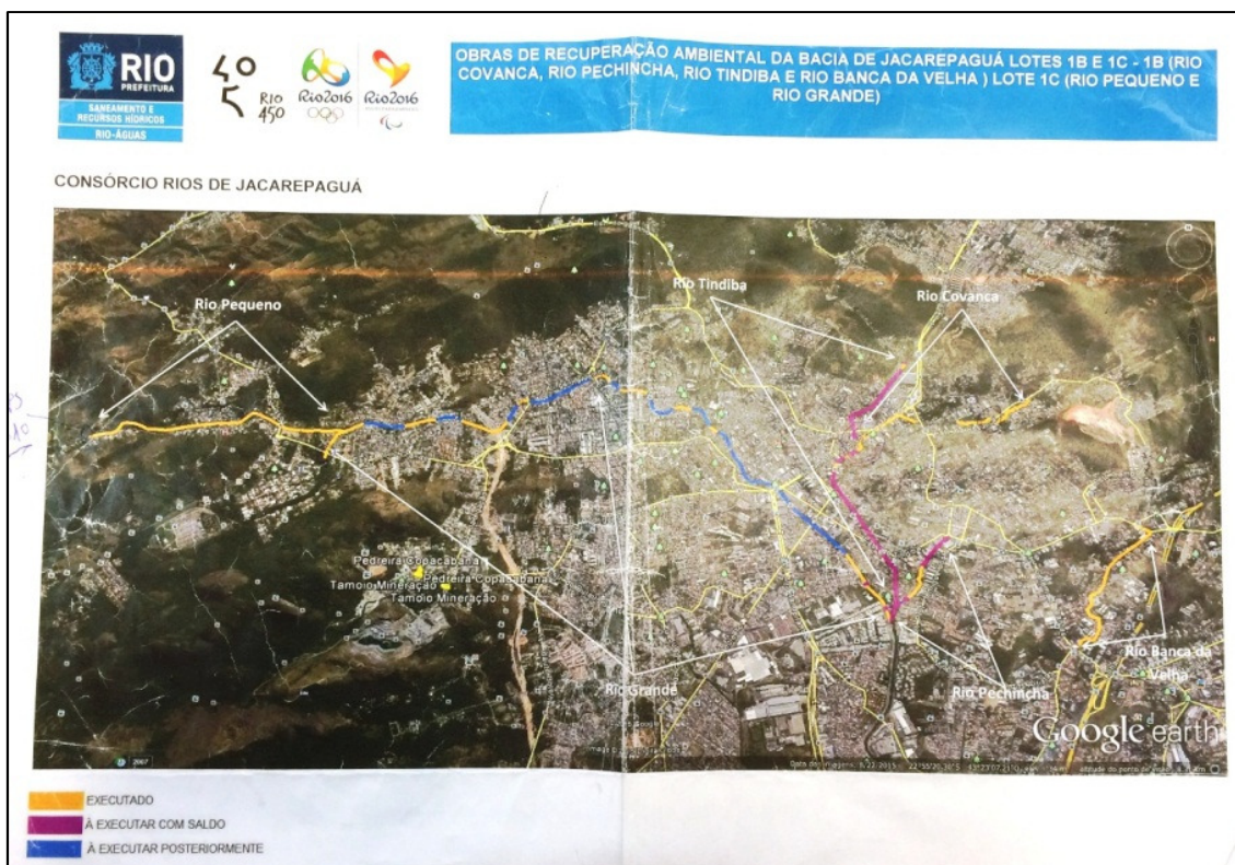
Foto 01 – Diagrama de execução das obras de Recuperação Ambiental da Bacia de Jacarepaguá. Apenas os trechos em laranja foram executados. – Documento fornecido pela fundação Rio Águas em 22/10/2015. Rio de Janeiro (RJ).
