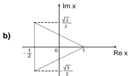
$$\text{O triângulo formado é equilátero de lado} = \sqrt{\left(\frac{\sqrt{3}}{2}\right)^2 + \left(-\frac{1}{2} - 1\right)^2} = \sqrt{\frac{3}{4} + \frac{9}{4}} = \sqrt{3}$$
