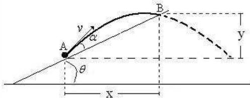
O alcance ao longo do plano inclinado é  $d = \sqrt{x^2 + y^2}$ . As coordenadas  $x$  e  $y$  do ponto B têm as seguintes equações horárias:
