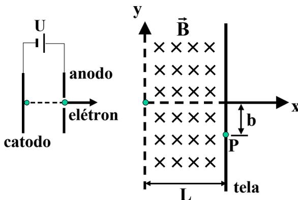
Se um ponto luminoso é detectado a uma distância  $b$  sobre a tela, determine a expressão da intensidade de  $\vec{B}$  necessária para que os elétrons atinjam o ponto luminoso  $P$ , em função dos parâmetros e constantes fundamentais intervenientes. (Considere  $b \ll L$ ).
