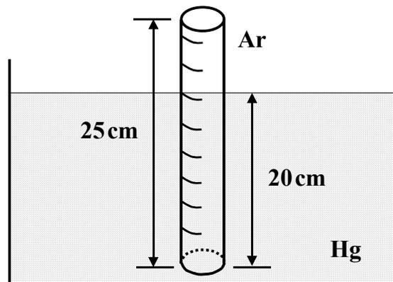
Considerando uma pressão atmosférica de 75 cm Hg, calcule a altura da coluna de mercúrio remanescente no interior da pipeta.
