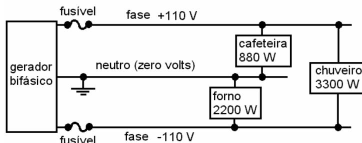
Admitindo que os aparelhos funcionam simultaneamente durante duas horas, calcule a quantidade de energia elétrica consumida em quilowatt-hora (kWh) e, também, a capacidade mínima dos fusíveis, em ampére.
