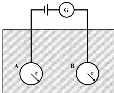
Sabendo que  $RC = \varepsilon / \sigma$ , em que  $\sigma$  é a condutividade do solo,  $C$  é a capacitância do sistema e  $\varepsilon$  a constante dielétrica do solo, pedem-se:
