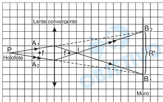
Observe que o raio ( $3u$ ) do círculo iluminado não se altera com a colocação da lente.
