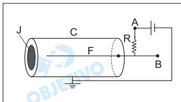
A figura representa uma câmara fechada **C**, de parede cilíndrica de material condutor, ligada à terra. Em uma de suas extremidades, há uma película
