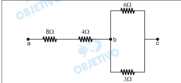
Sabendo-se que a diferença de potencial entre os pontos a e c é de 42 V, as correntes que passam nos resistores de  $4\ \Omega$ ,  $6\ \Omega$  e  $3\ \Omega$  são, respectivamente,
