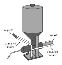
Em cada lado do recheador, há duas alavancas unidas por um pivô, uma delas, reta e horizontal, e a outra, parte vertical e parte transversal. A alavanca maior encontra na base do aparelho outro pivô e, na outra extremidade, um manete, onde é aplicada a força. A alavanca menor se conecta à extremidade do êmbolo que está em contato com o doce de leite, pronta para aplicar, no início do processo, uma força horizontal.
