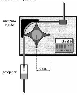
Regulando-se o aparelho para girar com frequência de 0,25 Hz, pequenos roletes das pontas da estrela, distantes 6 cm do centro desta, esmagam a mangueira flexível contra um anteparo curvo e rígido, fazendo com que o líquido seja obrigado a se mover em direção ao gotejador. Sob essas condições, a velocidade escalar média imposta ao líquido em uma volta completa da estrela é, em m/s,
