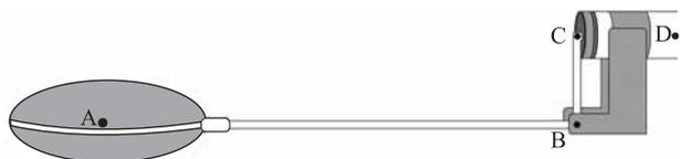
Considere que, em condições normais de funcionamento, uma bóia mantenha a entrada de água fechada ao ter metade de seu volume submerso na água do reservatório. Uma vez que os braços AB e BC da alavanca em "L" guardam entre si a proporção de 5:1, a intensidade da força com que a alavanca empurra a válvula contra o cano, em N, é
