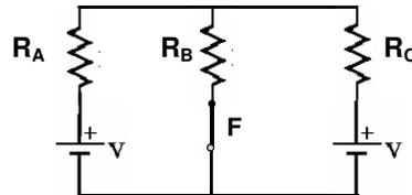
a) A corrente nos resistores  $R_A$ ,  $R_B$  e  $R_C$ .
