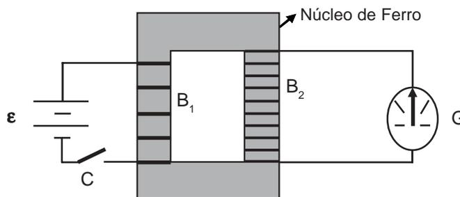
Nessa figura, uma bateria de tensão constante  $\epsilon$  é conectada a uma chave interruptora **C** e a uma bobina **B<sub>1</sub>**, que, por sua vez, está enrolada a um núcleo de ferro doce, ao qual também se enrola uma outra bobina **B<sub>2</sub>**, esta conectada a um galvanômetro **G**, que poderá indicar a passagem de corrente elétrica.
