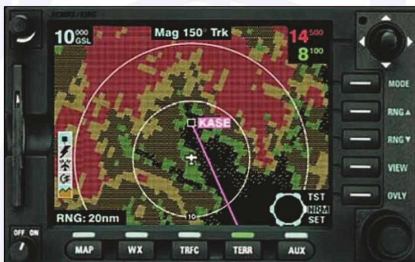
Figura 5 - MFD do mesmo modelo da aeronave PR-SOM, selecionado no modo de terreno, e exibindo as informações do EGPWS.
