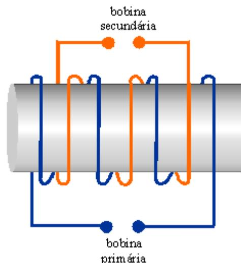
Com o avanço da nanotecnologia, é possível construir transformadores com bobinas de dimensões infinitesimais. A figura acima mostra esquematicamente um desses transformadores com duas bobinas denominadas primária e secundária, as quais estão enroladas sobre um mesmo cilindro não-condutor. Os números de espiras das bobinas primária e secundária são iguais a 100 e 200, respectivamente. Com base nessas informações, julgue os itens a seguir.
