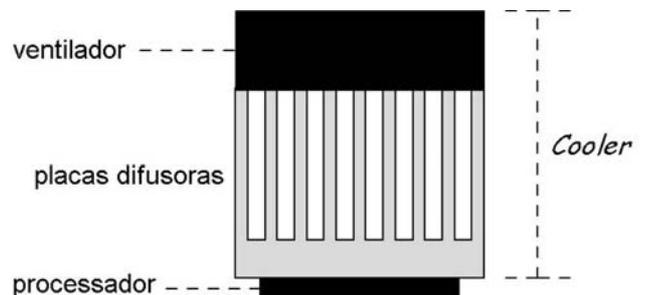
Figura 10: Vista lateral do *cooler* e do processador.
