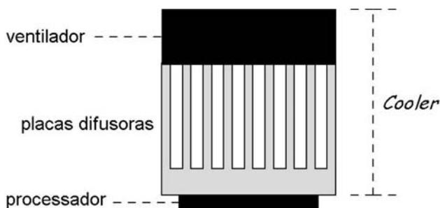
Figura 6: Vista lateral do cooler e do processador.
